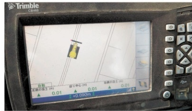
オペレーターは運転席のモニターを見ながら作業の進ちょくを確認する
