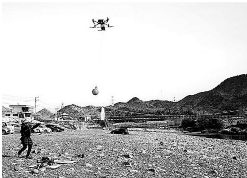
救助で使うブイを空輸するドローン。中継点で別の機体に移し替えた＝美濃市前野、長良川河川敷
