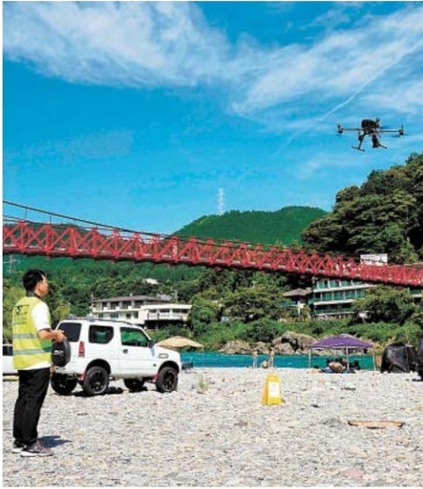
高性能スピーカーを搭載した産業用ドローン。自動操縦で約1キロ間を往復した＝美濃市前野、長良川
