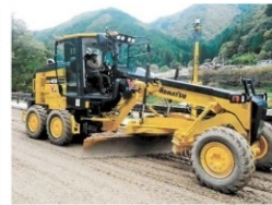
位置情報を計測してブレードの高さや勾配を自動制御するICTブレードモニターで設計データや重機の位置、ブレードの高さなどの情報を把握できる ■下呂市馬瀬黒石
