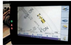
位置情報を計測してブレードの高さや勾配を自動制御するICTブレードモニターで設計データや重機の位置、ブレードの高さなどの情報を把握できる ■下呂市馬瀬黒石
