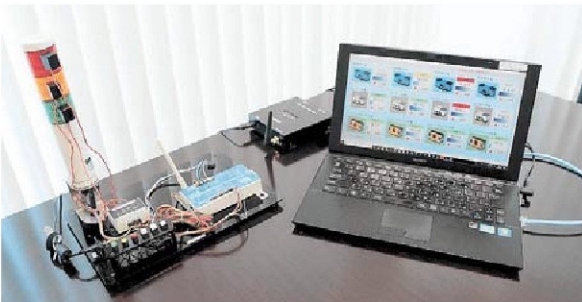
積層表示灯のセンサーで生産設備稼働状況を一元管理できるIoTシステム
